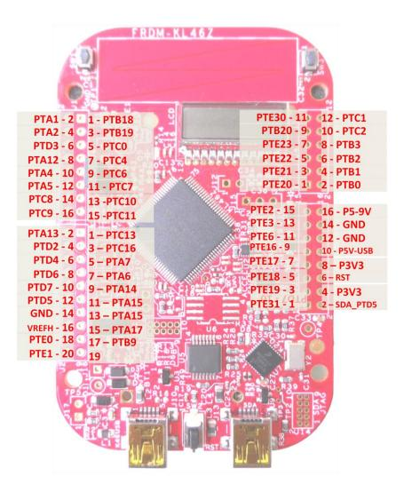
Figure 8 FRDM-KL46 Pin-Out
