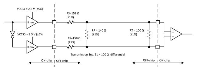
Figure 3.1. LVDS25E Output Termination Example
