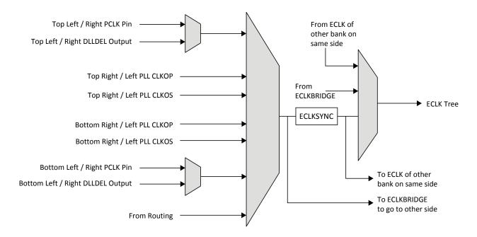
Figure 2.8. Edge Clock Sources per Bank
