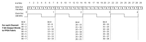
Figure 3.10. DDRX71 Video Timing Waveforms
