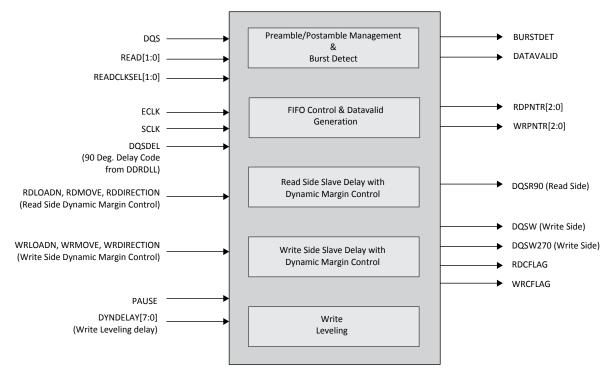
Figure 2.24. DQS Control and Delay Block (DQSBUF)
