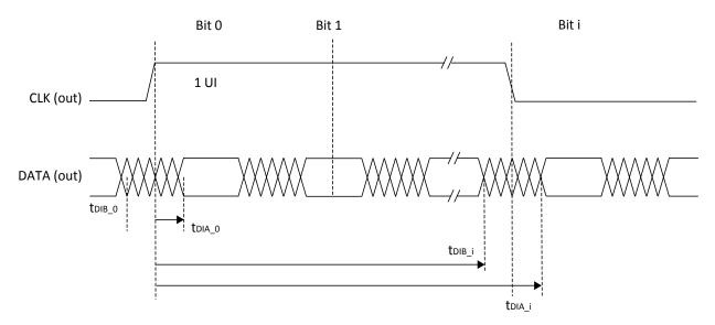
Figure 3.12. Transmitter DDRX71\_TX Waveforms
