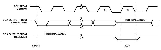
FIGURE 13. ACKNOWLEDGE RESPONSE FROM RECEIVER
