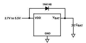
FIGURE 21. SUPERCAPACITOR CHARGING CIRCUIT
