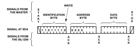
FIGURE 14. BYTE WRITE SEQUENCE
