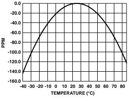
FIGURE 18. RTC CRYSTAL TEMPERATURE DRIFT
